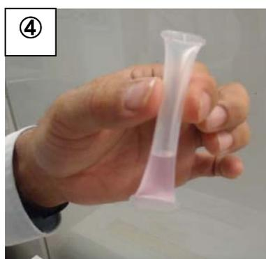
⑤ 試薬に水を入れ軽く振り混ぜて10秒後、色が薄くてもピンク色に反応すれば、飲み水として使用可能。
