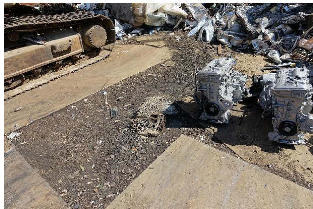
(土壌・地下水汚染防止対策が不十分な床面)
