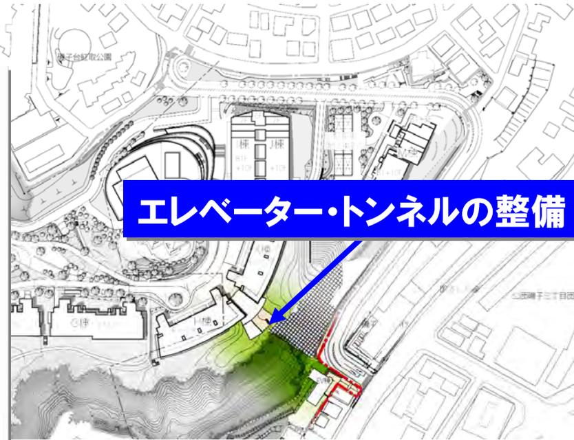
**エレベーター(高さ約60m)、トンネル(幅員約3m、延長約60m)**
