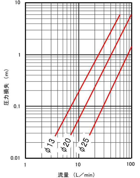
S50 形ダクタイル鋳鉄管用サドル付分水栓 (50×50(穿孔孔 40))の損失水頭
