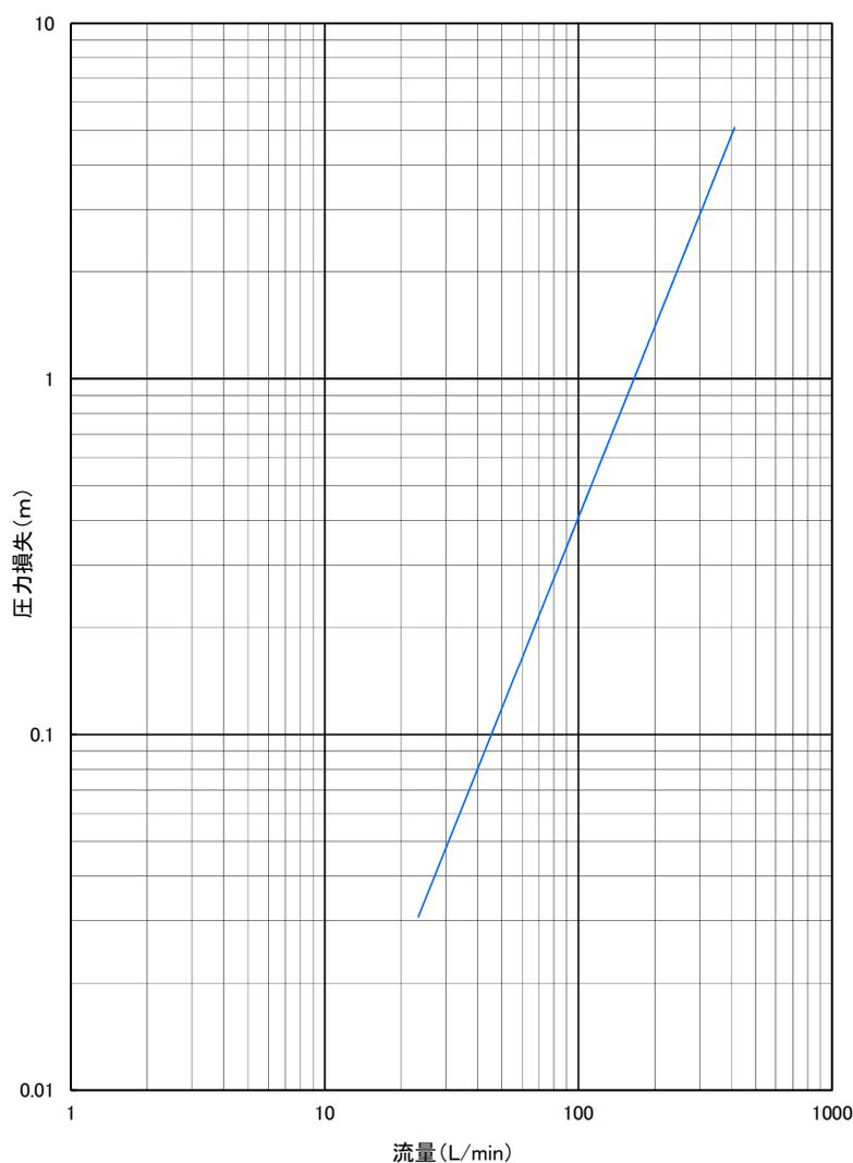
ウ 各種給水用具類などによる損失水頭の直管換算長
