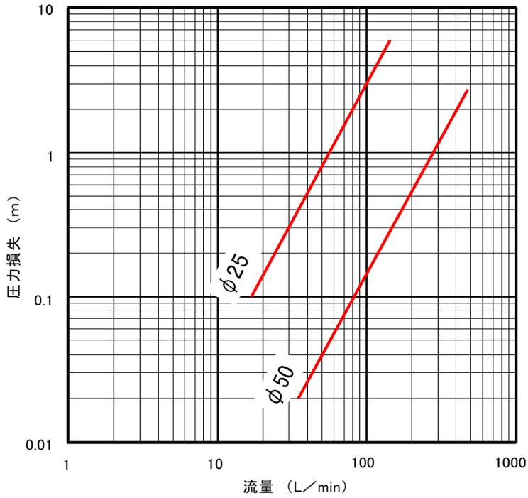
B型補助止水栓の損失水頭
