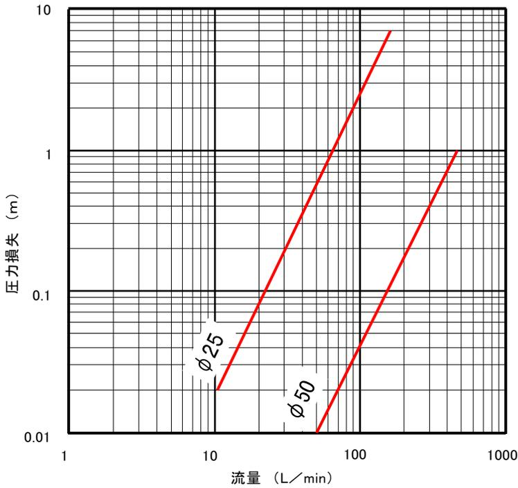
メーター用自在継手の損失水頭の損失水頭
