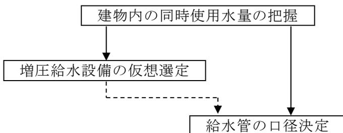
(2) 配水支管への影響、流水音、ウォーターハンマ等への配慮から、給水管内の流速は過大にならないようにすることが必要である。
