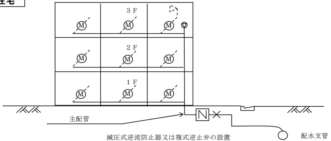
(8) 直結増圧式及び増圧給水設備の設置を猶予する場合、立ち上がり管の最頂部等の適切な場所に停滞する空気を排出する機能と断水時等における負圧解消のための吸気機能を併せ持った吸排気弁を設置すること。
