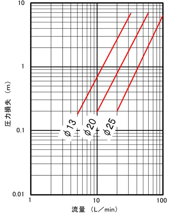
分水サドル用自在継手の損失水頭
