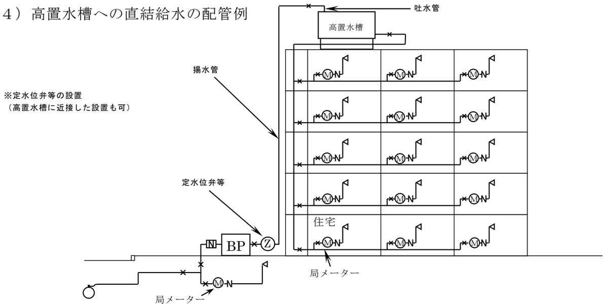
ア 高置水槽での吐水管口径は、設置又は設置を予定する増圧給水設備の口径と同口径とする。
