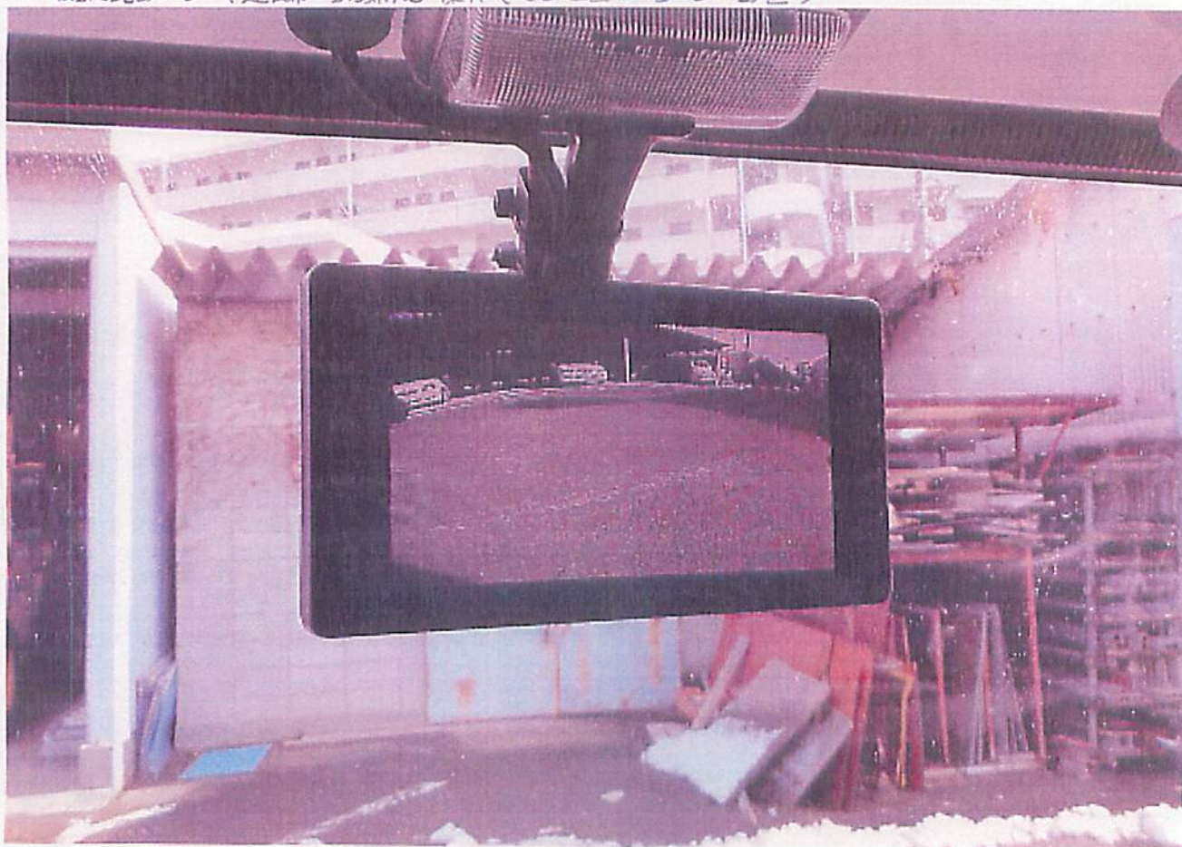
後部確認カメラ (運転席・助手席の操作できる位置にモニター設置)
