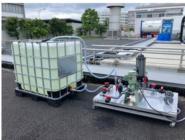
再生水(写真左)と消化ガス(写真右)の供給
