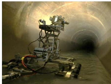
中大口径管用 TV カメラの例
