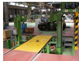
台車分解組立装置
