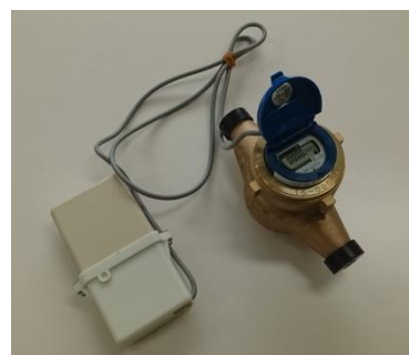
スマートメーター
