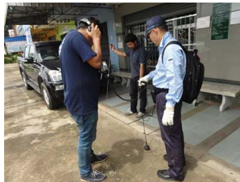
現地での漏水調査 (タイ)
