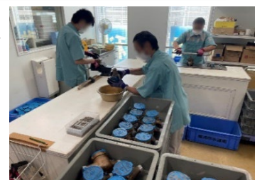
水道メーター分解作業
