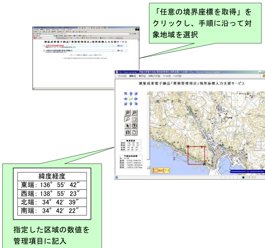
図 12-2 測量成果電子納品「業務管理項目」境界座標入力支援サービス
