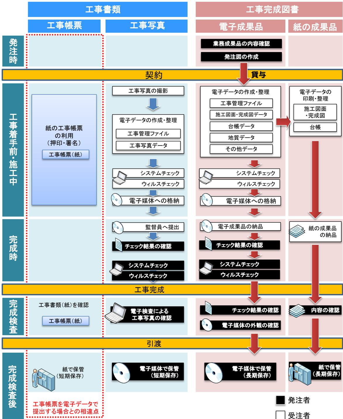
図 2-1 機械設備工事における電子納品・電子検査の流れ
