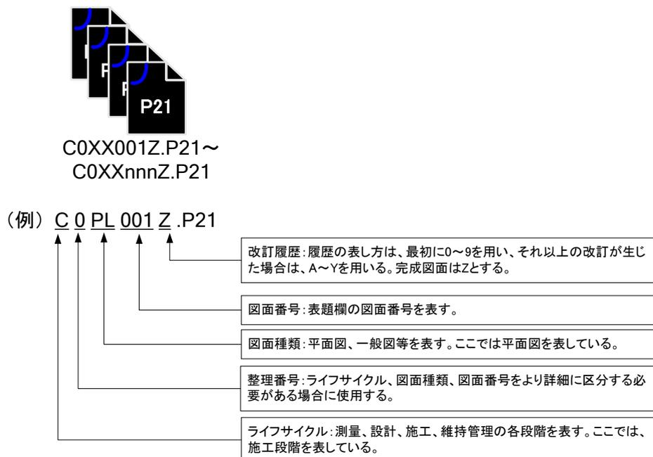
図 5-5 施工図面・完成図ファイルの命名 (例)
