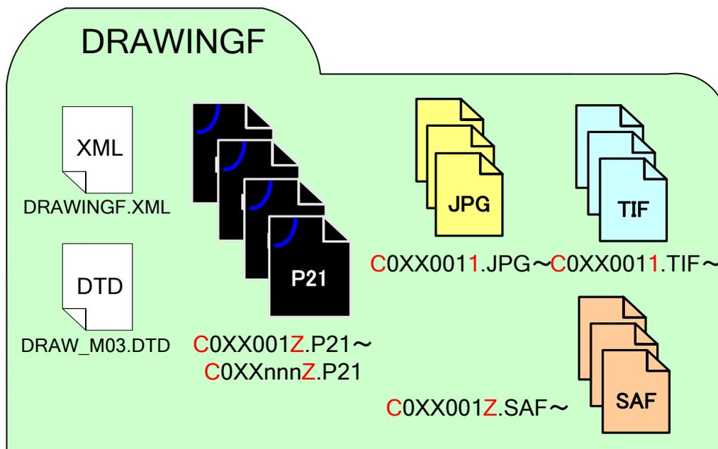
図 5-6 施工図面・完成図フォルダ（DRAWINGF）の格納イメージ（SXF Ver. 3.0 の場合）
