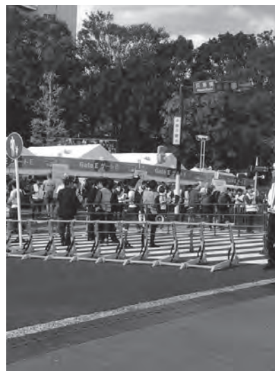
車両突入防止柵
