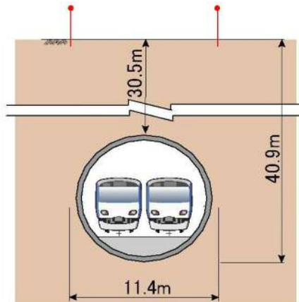
図 1-2 (3) 円形トンネル概略断面図 (③)
