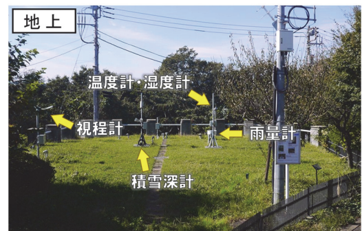
図 4 公園内での観測機器の設置状況の一例
