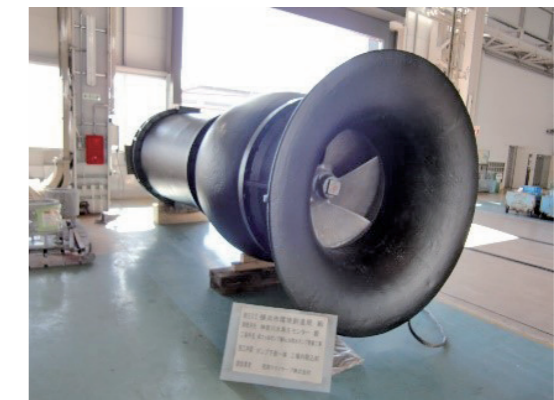
再整備後のポンプ設備
