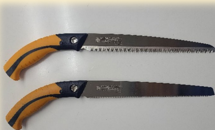
枝打ち用ノコギリ(上) 竹挽き用ノコギリ(下)
