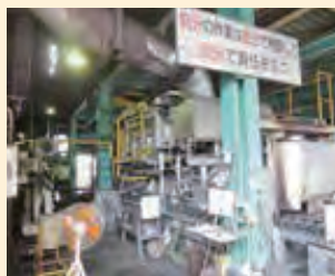
省エネ型・ 高効率熱処理炉の導入
