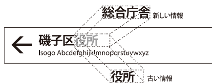
(短期メンテナンス) 修正用シートの貼り込み
