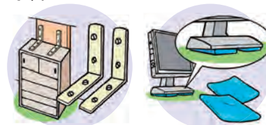
L字金具、ベルト (壁に強度が必要) 粘着マット (有効期限に注意)
