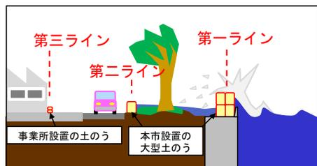
「三重の防護ライン」の構築による金沢産業団地への浸水防護
