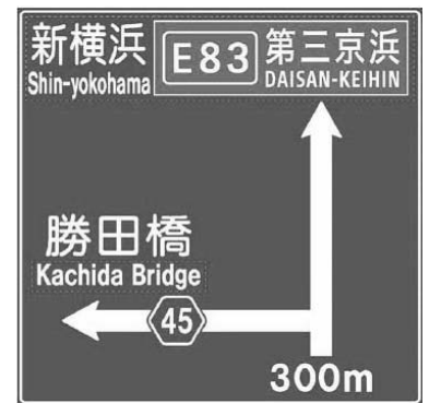
道路標識の改善イメージ 英語表記の改善、高速道路ナンバリングの追加
