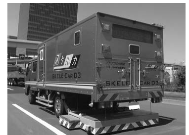
空洞探査車による調査
