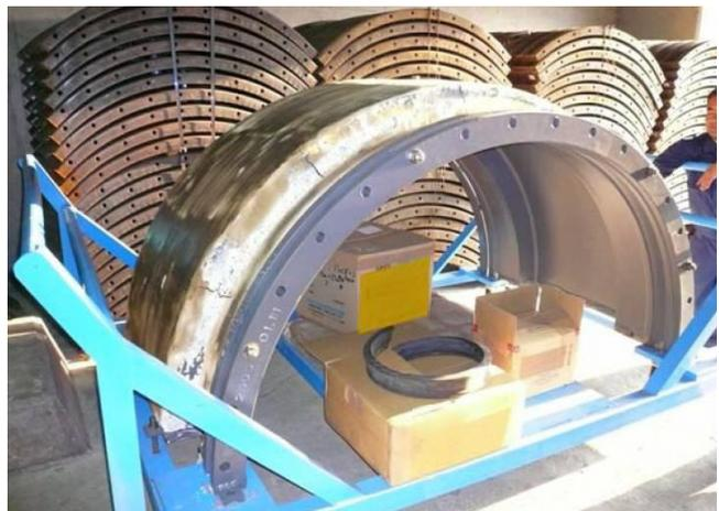
写真7 施設内に備蓄している大口径管カバージョイント
