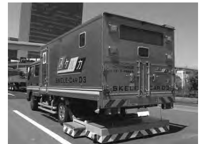
空洞探査車による調査
