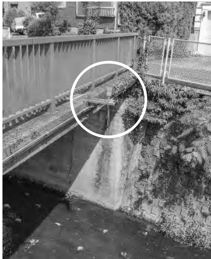
令和2年度に新設した水位計 (港南区 御所が谷橋 (準用河川日野川))
