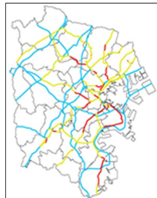
図2 大地震時に想定される建物倒壊による通行障害の状況（特に重要な道路）
