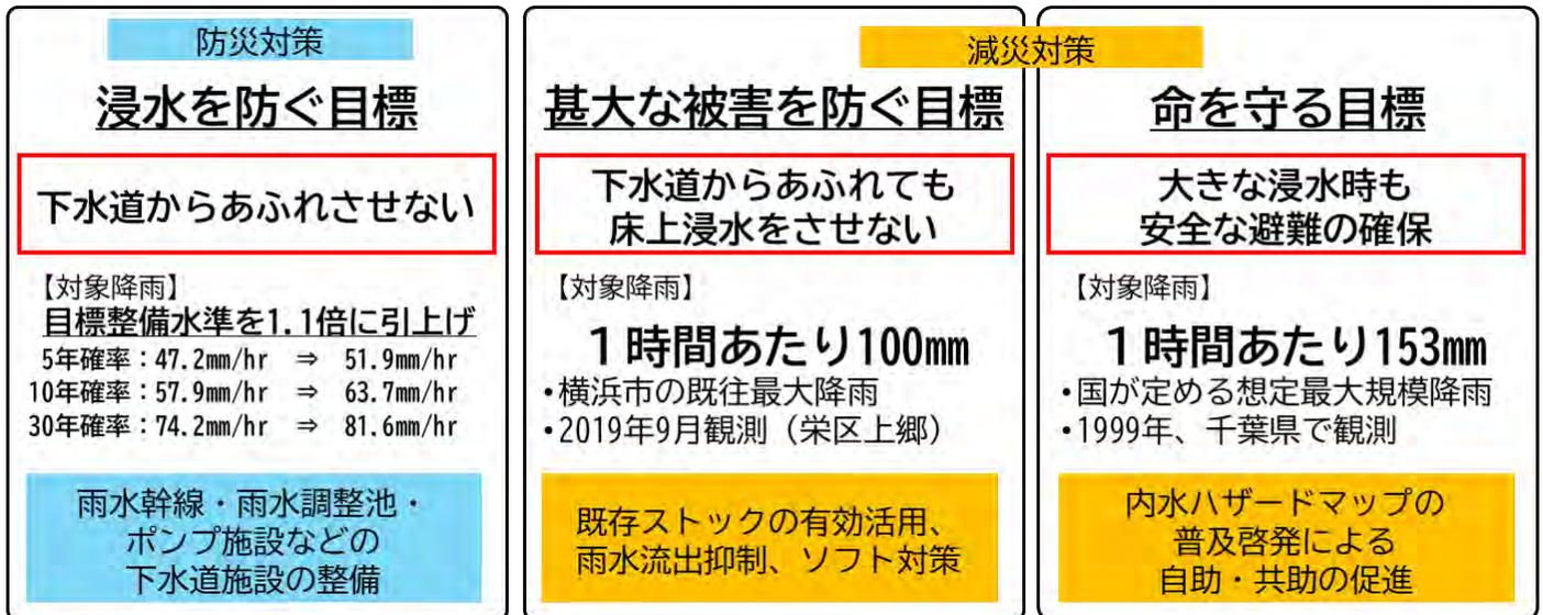
図8 下水道浸水対策における3つの目標
