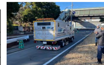
写真4 空洞探査車による点検
