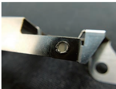
バーリングかしめによる組立構成
