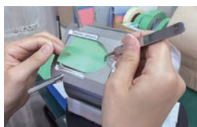
熟練技能者マスキング(誤差精度0.5mm)
