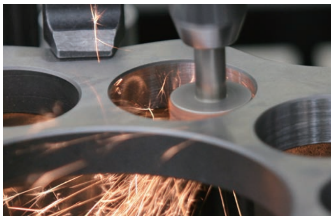
ジグ研削加工の様子、内径研磨
