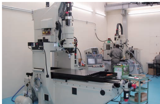
ジグ研削盤のメンテナンス
