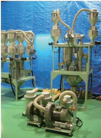
オリジナル設計されたスクリュー攪拌羽根を組み合わせ様々な材料を計量混合することにより短時間で高品質の材料を投入することが可能です。
