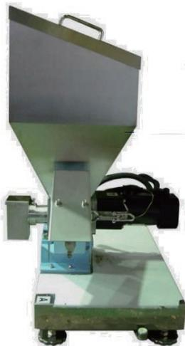
「材料を連続して出したい」「粉、ペレット等を微量に計りたい」等の要望に対して材料に合わせた正確な計量が可能な装置です。
