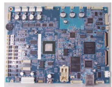
画像収集装置プリント回路基板
